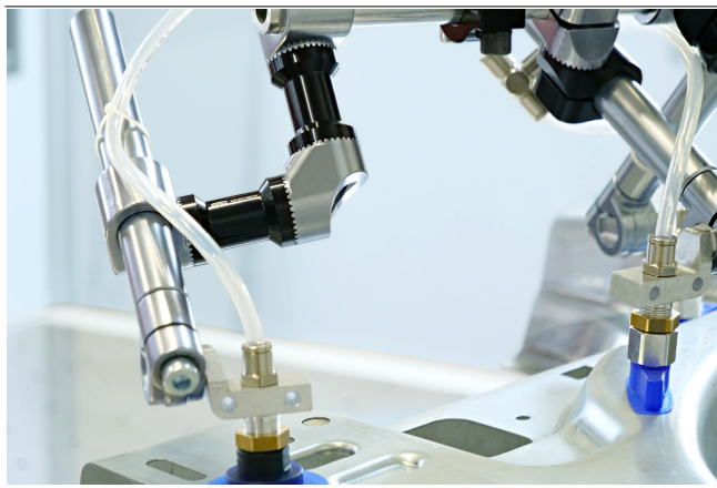
Conexión (dentada) SXT-CON-GB manipulando una pieza de chapa estampada
